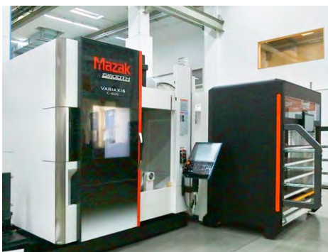
Mazak 5-Achs-Bearbeitungszentrum Variaxis C-600 ausgestattet mit dem RC-50 Platinum Side Loader – eine Messeneuheit erstmals in Deutschland präsentiert auf der AMB 2022 in Stuttgart.
