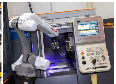
Eine clevere plug&work-Automationslösung zum einfachen Nachrüsten – die GARANT Automation der Hoffmann Group.
