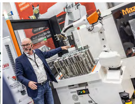
Mazak Drehmaschine QTE-300MSY mit turn-assistent von RoboJob zum automatischen Bestücken und Entladen der Maschine.
